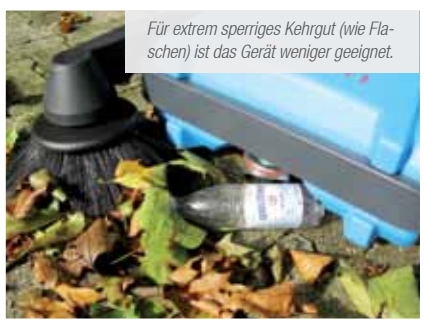
Die Maschine ist mit einer Walze und einem Seitenbesen ausgerüstet, der von einer Gummilippe umrahmt sind.
