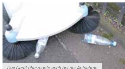
Das Gerät überzeugte auch bei der Aufnahme von größeren Objekten. In diesem Fall wurden zwei 0,5 l Flaschen vor die Walzen gefegt ...
