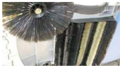
Das Gerät arbeitet nach dem Doppelwalzen-Überwurfprinzip. Die Walzen rotieren dabei gegenläufig.
